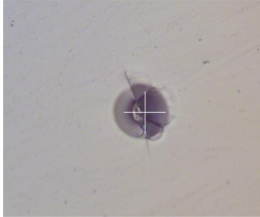
Abbildung 53: *Durch eine Schädigung knapp unterhalb der Oberfläche kommt es zu Verformung und Rissbildung. Das zu sehende Fadenkreuz hat eine Länge von  $50\ \mu\text{m}$ .*
