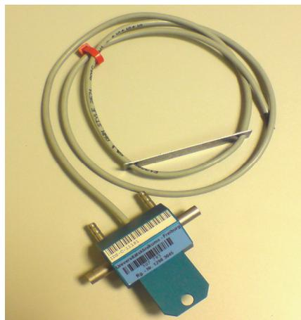
**Abbildung 13: Verwendeter Pneumotachograph**
