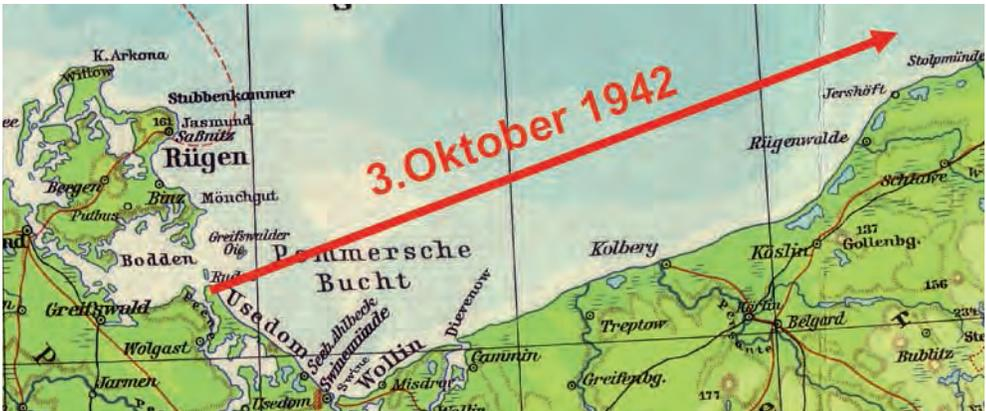
Abb. 6: Flugstrecke der vierten Testrakete der Serie A4 vom 3. Oktober 1942. Bei späteren Versuchen wurden Entfernungen von fast 300 km erreicht. Bei diesem Versuch mit 190 km Entfernung erreichte die A4 erstmals eine berechnete Höhe von 82 km und damit den Weltraum. Das Protokoll vermerkt „zu steil“.
