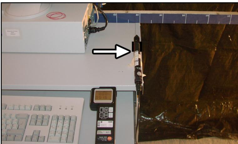
Abbildung 12: Luftgeschwindigkeitsmessung mit dem Testo term in 20cm Entfernung von der Öffnung des Netzteillüfters (Acer Veriton 5100) (Pfeil).
