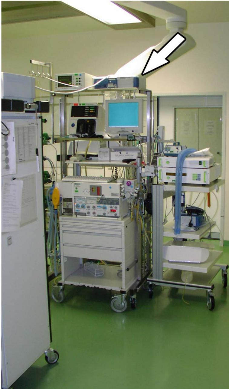
Abbildung 4: Ein Arbeitsplatzcomputer Acer Veriton 5100 (medical approved nach EN 60601-1-1-1) der Anästhesie im operativen Bereich (Pfeil).
