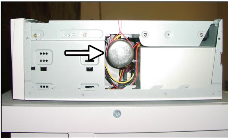
Abbildung 5: Position des TDL in Netzteilnähe im Acer Power 4400 für die Temperaturmessungen (Pfeil).
