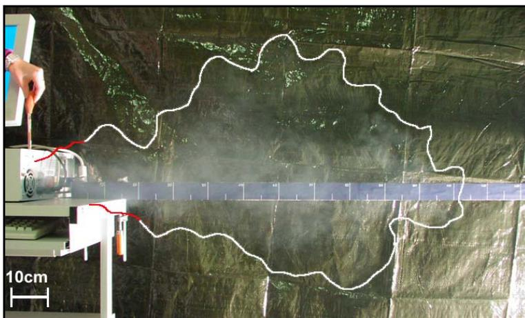
Abbildung 19: Optische Darstellung des Luftstromes beim Acer Power 4400.
