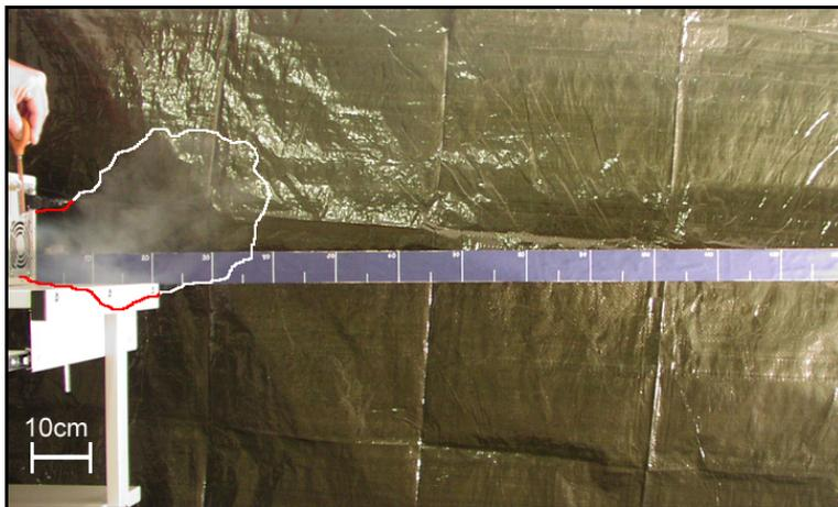
Abbildung 18: Optische Darstellung des Luftstromes beim Peacock Procida.
