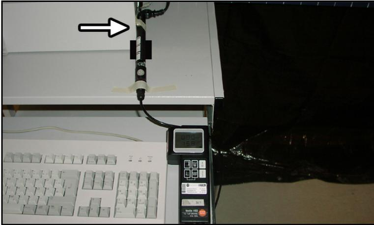
Abbildung 11: Luftgeschwindigkeitsmessung mit dem Testo term in 0cm Entfernung von der Öffnung des Netzteillüfters (Acer Veriton 5100) (Pfeil).
