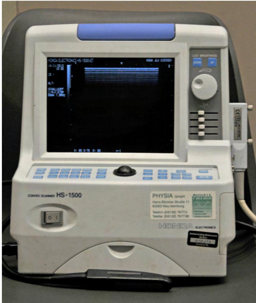
**Abb. 4: Portables Honda HS-1500 Ultraschallgerät der Firma Physia GmbH zur Durchführung der Grauwertanalyse**
