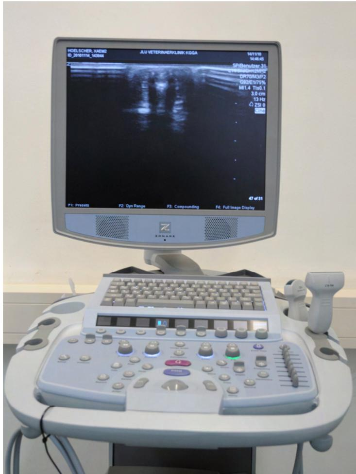
**Abb. 3: Zonare Z.one Ultraschallgerät der Firma Physia GmbH zur Erstellung der Aufnahmen im B-Mode Verfahren**
