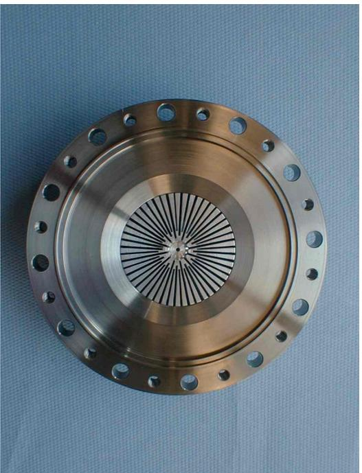
(b) 60 mm Lochblende (mit Flussverteiler aus Abb a)
