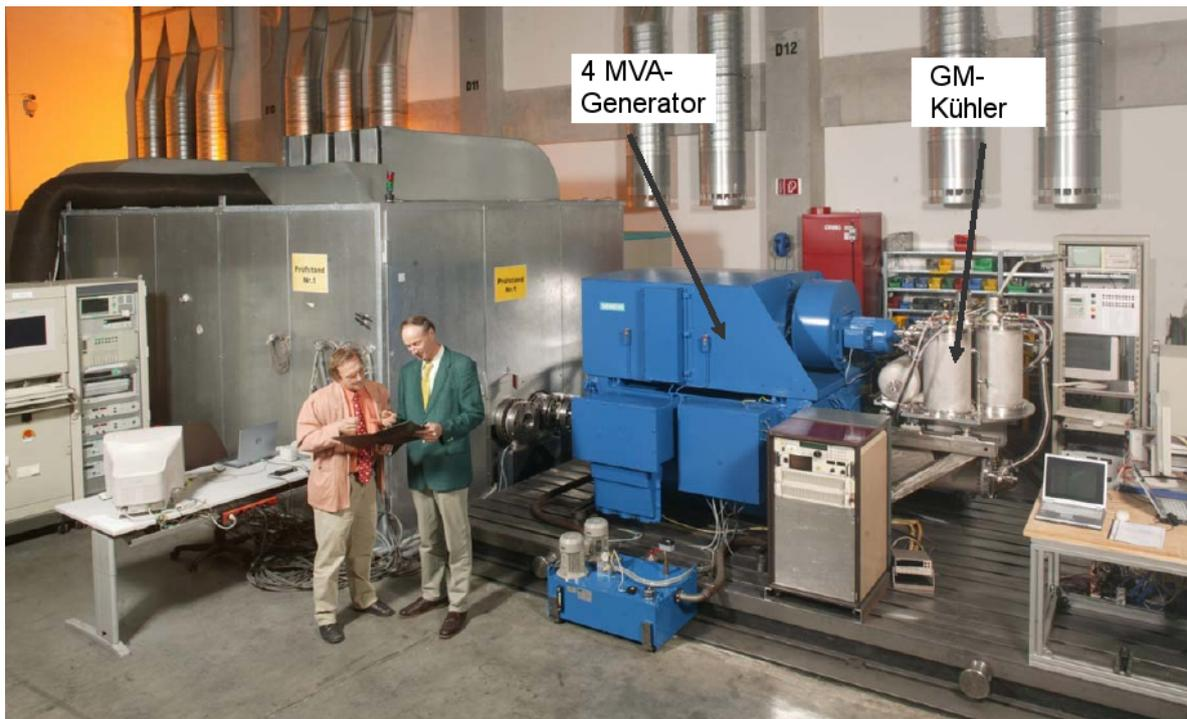
Abbildung 2.6: 4 MVA Generator im Testbetrieb bei Siemens mit zwei 1-stufigen GM-Kühlern [23].
