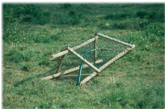
**Abb. 15:** Auseinanderbrechen eines Dreibocks nach zu hoher Belastung (Foto: Gerd Bauschmann)
