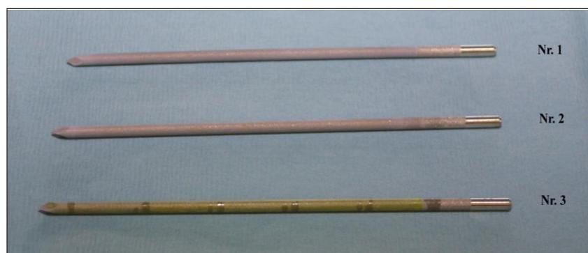
Abb.12: Nr. 1: Unbeschichteter K-Draht, Nr. 2: K-Draht mit Hydroxylapatit-Beschichtung, Nr. 3: K-Draht mit RGD-HA-Gentamicin-Beschichtung.
