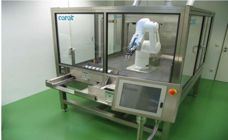
Abb. 14: Industrieroboter mit zum Aufbringen der Gentamicin-Beschichtung. Roboter mit Mehrgelenkarm und Spritzdüsenvorrichtungen zum Aufbringen der kombinierten Gentamicin-Sulphat-Crocefat-Beschichtung auf das Implantat durch InkJet-Verfahren (Firma Biomet, Berlin).
