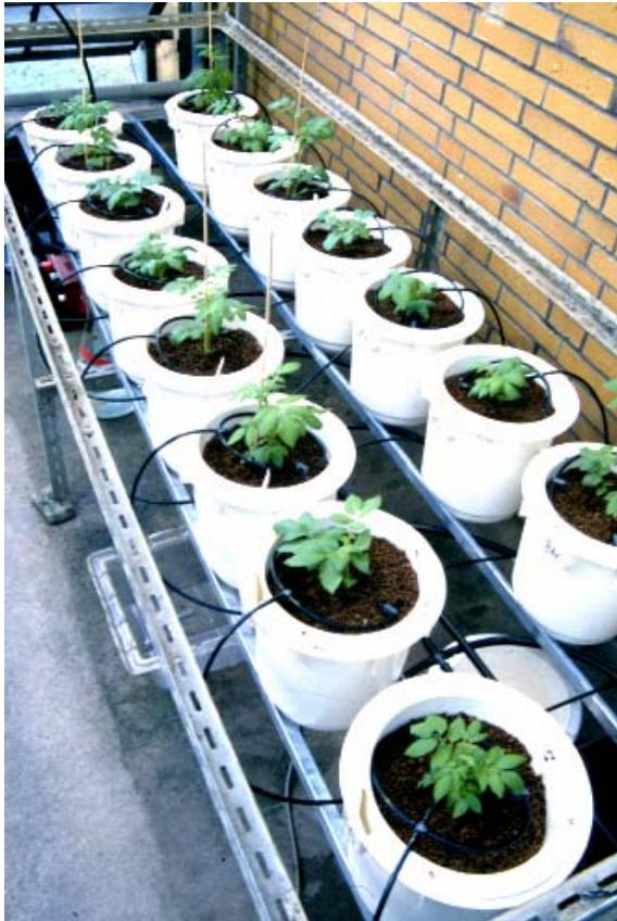
ABBILDUNG 3-2. Hydrokultursystem. Die Nährlösung wurde in regelmäßigen Intervallen (15 min je Stunde) aus einem Nährlösungsbehälter in die Töpfe gepumpt, von wo sie über eine Abflussleitung wieder zurück in den Behälter floss (nach Koyro & Huchzermeyer 1999).
