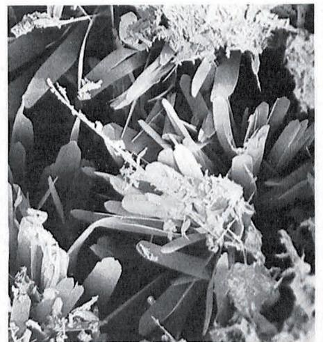
Bild 2: Elektronenmikroskopische Aufnahme von Tobermorit-Kristallen.
