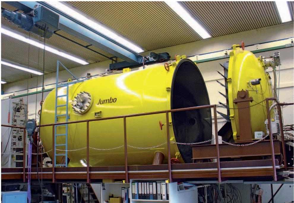
Abb. 1: Die Gießener Hochvakuum-Testanlage „Jumbo“ für Iontriebwerke; mit einem Kammervolumen von 30 m<sup>3</sup> und einer Pumpgeschwindigkeit von 100.000 Litern pro Sekunde ist sie der größte Prüfstand in Deutschland. Bild: JLU
