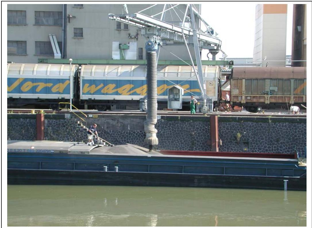
**Abbildung 6-5: Auslagerung von Raps in ein Frachtschiff**
