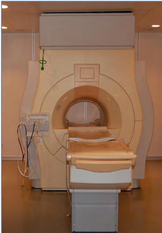
Abbildung 23: Die MRT-Untersuchungen für diese Arbeit wurden mit dem Gerät Gyroscan 1.0 Tesla der Firma Philips durchgeführt, einem geschlossenen supraleitenden System.
