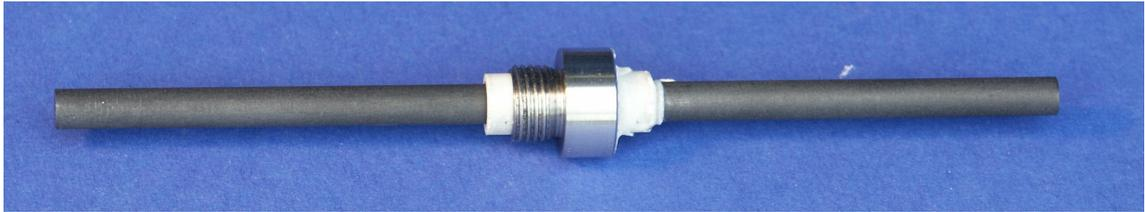
**Abbildung 4.9.:** Zentralelektrode aus Graphit
