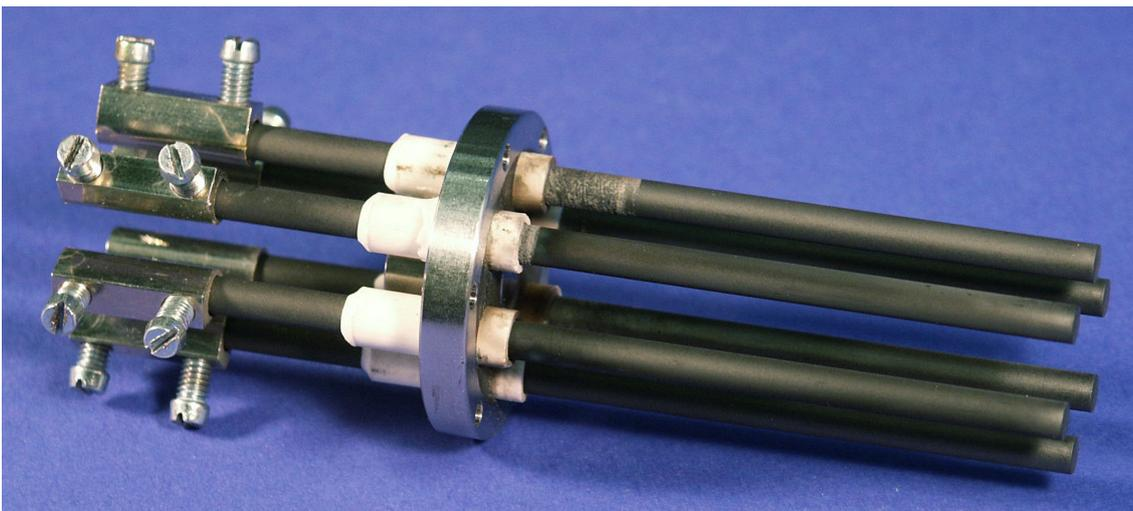
**Abbildung 4.8.:** Graphitelektroden nach 10h Betrieb mit 20W RF-Leistung
