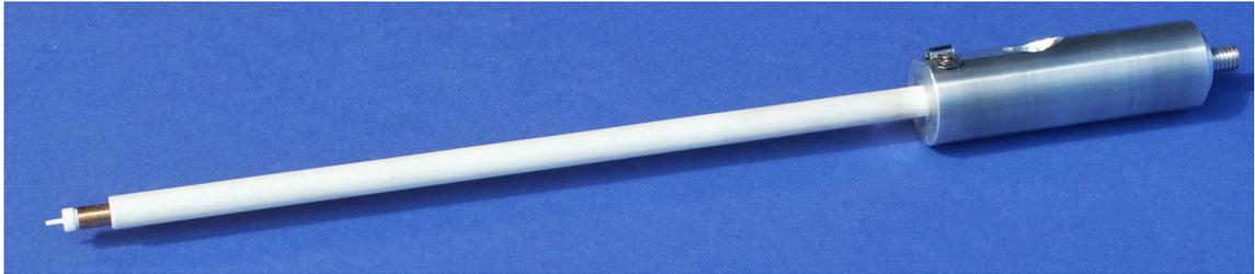
**Abbildung 5.21.:** Langmuirsonde 1-3 (hier in der Konfiguration 3) zum Einschrauben in Verfahrensdurchführung.
