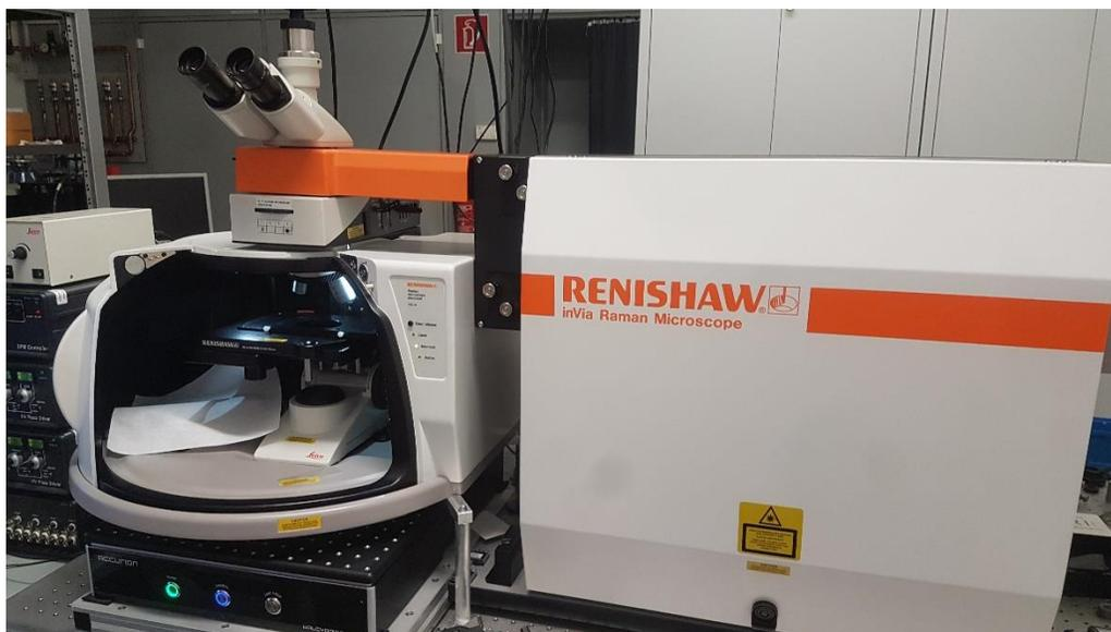
**Abbildung 14:** Aufbau des verwendeten Ramanmikroskops.
