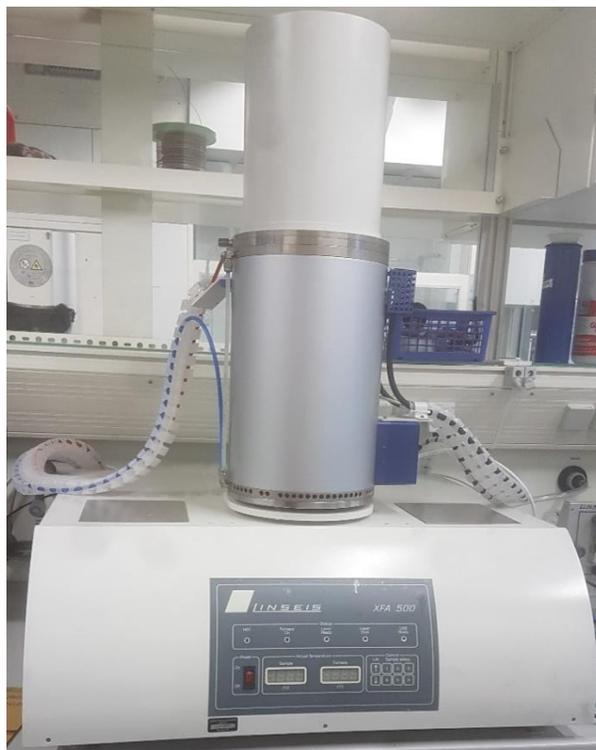
Abbildung 13: Xenon-Flash-Apparatur 500 der Firma Linseis.
