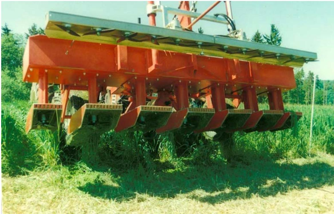
Abbildung 6: Arbeitswerkzeuge des Reihenmulchers
