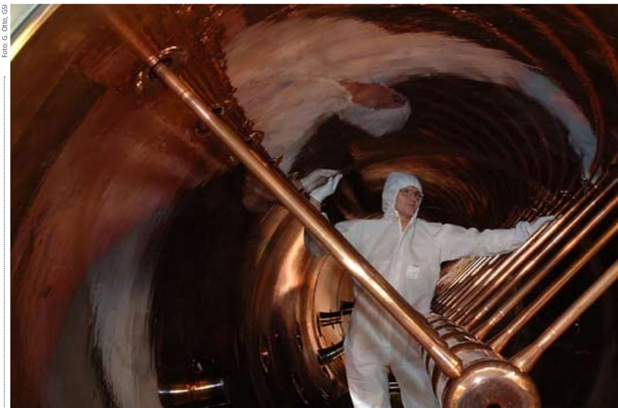
Blick in den 120 Meter langen Linearbeschleuniger UNILAC der GSI. Ionen können damit auf bis zu 20 % Lichtgeschwindigkeit beschleunigt werden. Nach der Realisierung von FAIR sollen die bereits existierenden Beschleunigeranlagen als Vorbeschleuniger dienen.
